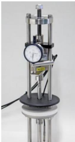
améliore la précision des mesures des tests de relaxation en modifiant la gamme des capteurs de force. Les capteurs de 500 N et 1000N ne sont plus proposés et sont remplacés maintenant par des capteurs de 600 N et 1200 N. Nous vous recommandons le capteur de 600 N pour des échantillons de Ø 13 mm ayant une dureté jusqu'à 80 ShA et le capteur 1200 N jusqu'à 90 ShA. Pour des échantillons plus épais ou plus durs, nous vous recommandons le capteur 2000 N.
